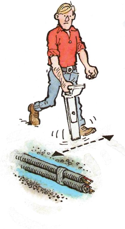
...Luego gire el localizador sobre un eje vertical hasta que obtenga un segundo pico. Cuando marque con precisión, probablemente sea necesario ajustar el control de sensibilidad para mantener la aguja en escala.
